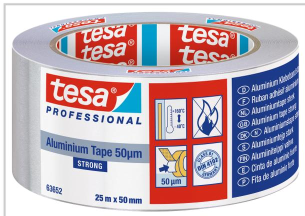
tesa® Strong 63652 est un ruban aluminium souple, composé d'un matériau de base en film d'aluminium (50 micron), d'un adhésif acrylique transparent et d'une couche de séparation blanche de 85 microns m en papier siliciné.
