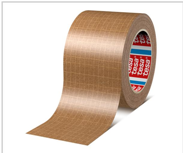
Ruban adhésif de carton en papier renforcé convient aux applications d'emballage à usage intensif (> 25 kg) convient aux applications d'emballage où un sceau de sécurité est requis (effet d'inviolabilité) adhérence élevée et tack très agressif haute résistance à la traction convient aux distributeurs/dévidoirs manuels et automatiques épaisseur : 210 µm coloris : chamois.
