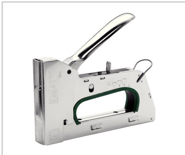
Puissante force de frappe système anti-recul chargement par l'arrière bloc-poignée pour le rangement chargeur de 84 agrafes pour agrafes n°140 de longueur 6-14 mm application : pose de matériaux d'isolation, lambris PVC, moquettes poids : 890 gr.
