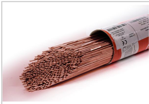
Métal d'apport plein cuivré utilisé pour le soudage sous protection gazeuse des aciers au carbone et faiblement alliés type S235, S355, S255N, S420N P235, P310
