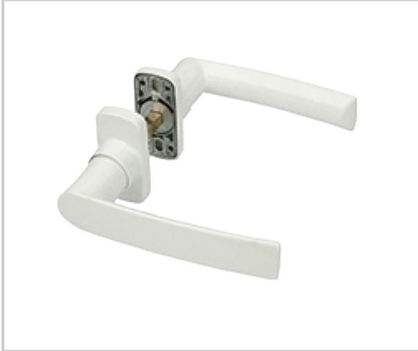
Béquille de porte en aluminium moulé sous pression avec ressort de rappel et rosace cache-vis à maintien de position par ressort. Base en aluminium moulé sous pression, douille de rotation en nylon, ressort et rondelles en acier inox. Axe carré de 8mm et vis de fixation en acier zingué. Grâce à un système de production différent, on peut également la réaliser dans les finitions anodisées.
