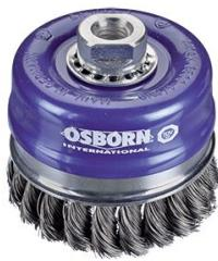
Brosse coupe à haute performance pour la finition de surface. La bague amovible évite l'écartement du garnissage. Il est possible d'enlever la bague une fois les fils usés, afin d'augmenter la durée de vie de la brosse. Pour l'enlèvement de scories, de rouille, l'ébavurage et le nettoyage.
