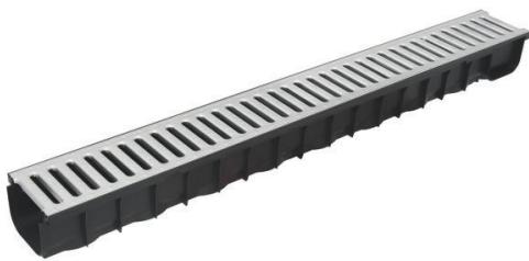
Caniveau Midi dimensions : 80X100 mm longueur 10000 mm avec un fond en plastique avec grille passerelle en acier galvanisé A15 montée cette caisse permet une résistance allant jusqu'à 1500 kg.
