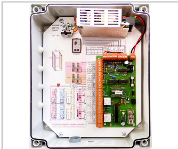
Centrale AC2 simplifiée pour la commande de SAS simple 2 portes. Pour ventouses, gâches, serrures autonomes (électronique intégrée). Gestion portiers lumineux, lecteurs, claviers etc...
