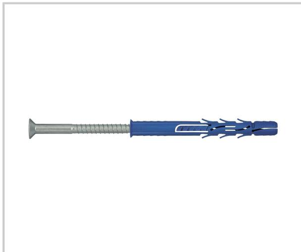
Cheville nylon à 4 directions d'expansion pour pose au travers de la pièce à fixer alternative au scellement chimique
