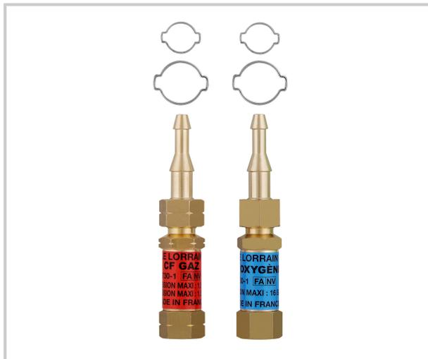
Anti-retour thermique stoppant le gaz vers l'amont et l'aval représente la sécurité maximale pour l'utilisateur (quand ils sont fixés à l'entrée du chalumeau) et pour l'installation (quand ils sont fixés à la sortie des détendeurs) équipé de clapets anti-retour, de bague en métal fritté et d'une pièce en métal fusible qui fond à 90 °C (provoquant ainsi la coupure d'arrivée du gaz)
