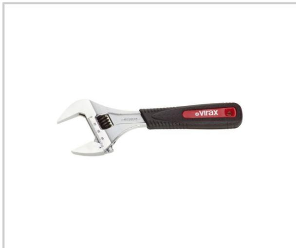
Mâchoire à grande ouverture résistance à la torsion permet de remplacer 3 clés à molette (6" -8" -10" pour 0151796, 8" -10" -12" pour 0017972) ergonomique : manche gainé antidérapant pour une meilleure prise en main pour les espaces restreints : épaisseur réduite des bouts de becs et mâchoire mobile non saillante en position ouverte.
