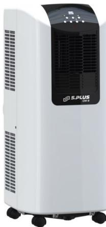
Utilisation en industrie, zones de travail, locaux tertiaires ,magasins ou halls d'expositions, hôpitaux, les maisons de retraitepuissance frigorifique 2300W - 8000 BTU/hdébit d air :310m<sup>3</sup>/h2 allures pour traitement de 18 à 32°Cminuteur et thermostat électroniquegaine adaptateur avec fenêtre plat poids : 22 Kg.
