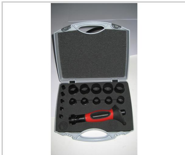
Découpe-joints en acier carbonepoignée bi-matière brevetée permet de faire des joints et rondelles dans différents matériaux (mousse, carton, cuir, caoutchouc, fibre, plastique, plomb,...) composition : Ø3-4-6-8-10-12-14-16-18-20-22-24-26-28-30mm livré en coffret.
