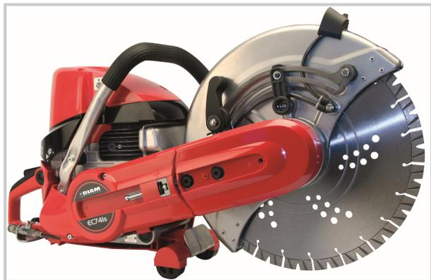
Adapté à tous les travaux de découpe sur les chantiers BTP carter et tête de coupe réversible pour une utilisation "ras de mur" filtre à air 4 étages : protège le moteur des poussières pompe d'amorçage, démarrage rapide, corde de lanceur préservée moteur 2 temps stratifié sans catalyse, puissant et robuste livrée avec 1 raccord à eau et 1 outillage disques conseillés : DSLMAXX ou X-FORCE.
