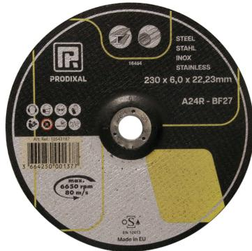
Disque à ébarber, en résine organique bakélite et toile de renfort fibres de verre abrasif : oxyde d aluminium applications : pour le meulage, l'ébarbage, le surfacage, l'arasage et le chanfreinage de toutes formes de pièces matériaux pouvant être usinés : aciers Carbone et aciers Inoxydables boîte de 10.
