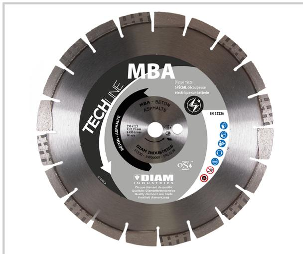
Disque apportant un gain énergétique pour les découpeuses sur batterie tôle perforée pour un meilleur refroidissement segments "duos" alternés pleins et crénelés d'une hauteur de 12 mm segment de protection contre le laminage sous segment à partir de diamètre 300 matériaux : asphalte, béton.
