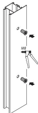
**3** Positionner la poignée et les vis sur le profil;
