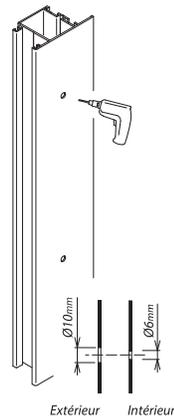
2 Positionner les poignées et les fixations sur le profil (Attention, ne pas serrer à fond et ne pas bloquer le barreau) ;
