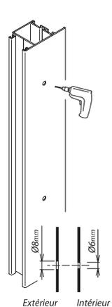
2 Positionner les poignées et les fixations sur le profil (Attention, ne pas serrer à fond et ne pas bloquer le barreau) ;
