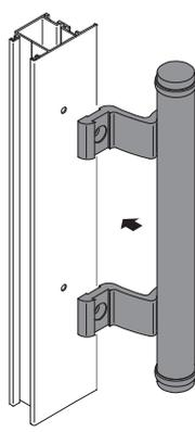
3 Placer les ensembles de fixation et serrer les vis ;
