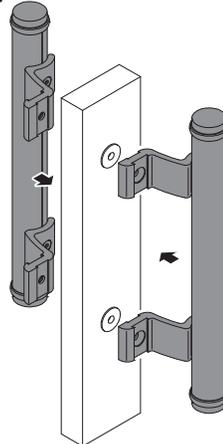
4 Placer les ensembles de fixation et serrer les vis ;
