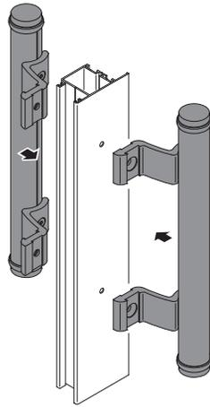
3 Placer les ensembles de fixation et serrer les vis ;
