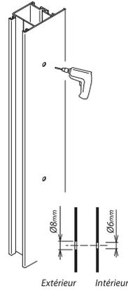
**2** Positionner les supports et les fixations sur le profil ;
