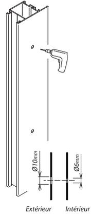
**2** Positionner les supports et les fixations sur le profil (Attention, ne pas serrer à fond et ne pas bloquer le barreau) ;
