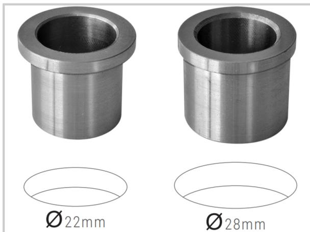
Fabriquée en acier au carbone zingué, avec anneaux de pression à ressort pour une meilleure fixation permet d'adapter les accessoires pour table de soudage de Ø 16 mm aux différents Ø d'alésage des tables.
