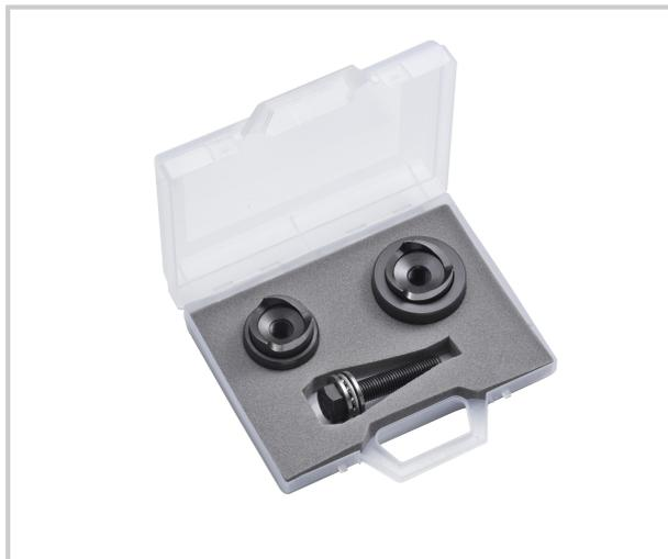
Emporte-pièces à tôles en acier carbone brunis permet de découper des trous sans bavure et non déformés dans des matériaux tels que l'aluminium, tube isolant, laiton et aciers doux jusqu'à 2 mm d'épaisseur. Sélection spéciale pour plombier. Composition : vis sans butée à bille + Ø32,5-35mm.
