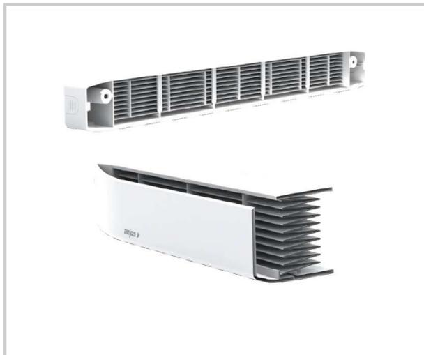
Pour garantir une filtration optimale, il est conseillé de changer le filtre chaque année. Cette intervention est simple à réaliser puisqu'elle ne demande aucun outil. Il suffit de déclipser la flasque avant de l'entrée d'air, retirer le filtre de son logement et insérer le nouveau filtre.
