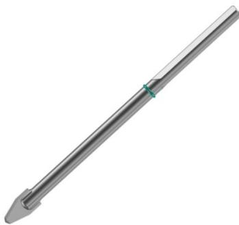
Foret à pointe diamantée Pour pierres naturelles, tuiles, carrelages, céram 3 méplats sur la tige du foret évitent le blocage des forets dans le matériau Changer de forets dès que le matériau fragile est traversé .
