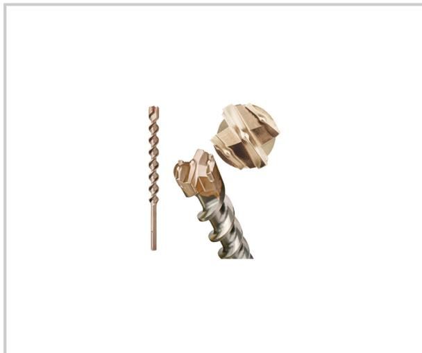
Foret marteau idéal pour le béton et la pierre. Egalement pour le béton armé et le granit. Carbure de tungstène, pointe auto-centrante, effet burinage. 6 taillants et 6 appuis latéraux. Hélice âme progressive, augmentation de la masse d'acier.
