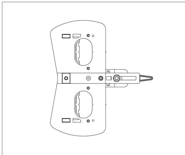
pour fraisage de 30mm double cuvette et perçage de 3mm des vis des paliers d'angle et paliers compas
