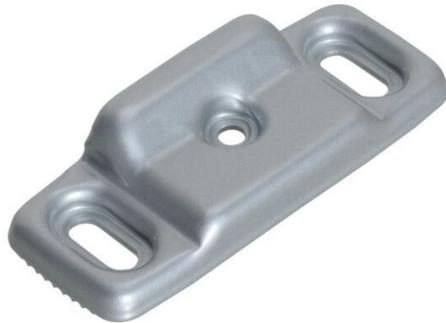
Gâche en tôle d'acier laqué pour serrures centrales et pênes haut-bas (à exclusion de l'art. 8401), utilisable sur portes à deux vantaux. Réglable en horizontal et applicable sur les profils coplanaires et sur ceux avec recouvrement jusqu'à 6mm, sans l'aide de cales supplémentaires. Apte pour portes coupe-feu.
