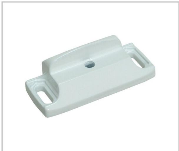
Gâche en zamac pour serrures centrales et pênes haut-bas (à exclusion de l'art. 8401I). Elle peut être réglée en horizontal et appliquée sur profils coplanaires et sur ceux à recouvrement jusqu'à 10mm,sans l'aide de cales supplémentaires.
