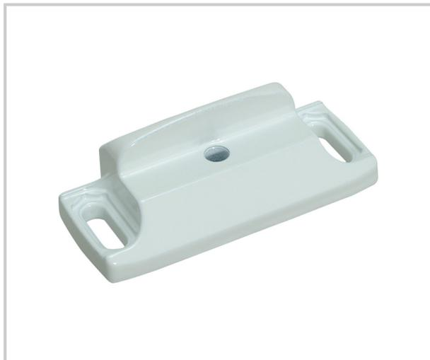
Gâche en zamac pour serrures centrales et pènes haut-bas (à exclusion de l'art. 8401I). Elle peut être réglée en horizontal et appliquée sur profils coplanaires et sur ceux à recouvrement jusqu'à 10mm, sans l'aide de cales supplémentaires
