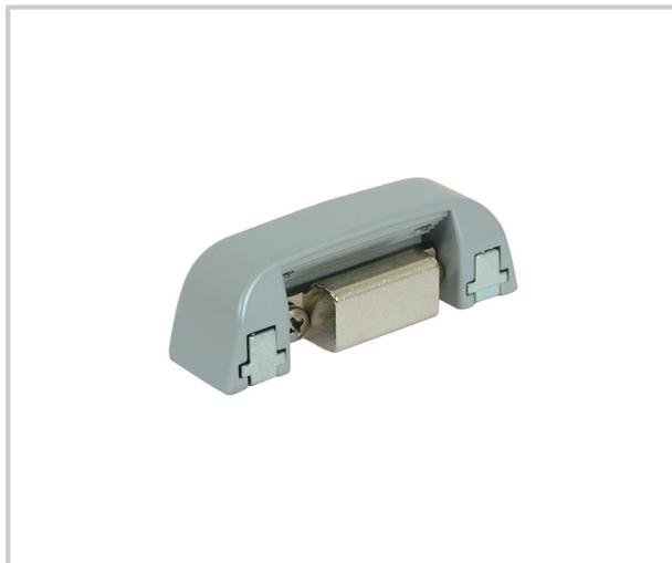
Gâche en zamac, utilisable su portes à deux vantaux, pour serrures centrales et pènes haut-bas (à exclusion de l'art. 8401I), réglable en vertical et en horizontal. Applicable sur profils coplanaires et sur ceux à recouvrement jusqu'à 11mm, sans l'aide de cales supplémentaires.
