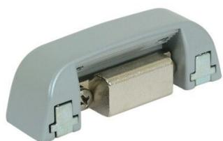
Gâche en zamac, utilisable sur portes à deux vantaux, pour serrures centrales et pênes haut-bas (à exclusion de l'art. 84011), réglable en vertical et en horizontal. Applicable sur profils coplanaires et sur ceux à recouvrement jusqu'à 9mm, sans l'aide de cales supplémentaires.
