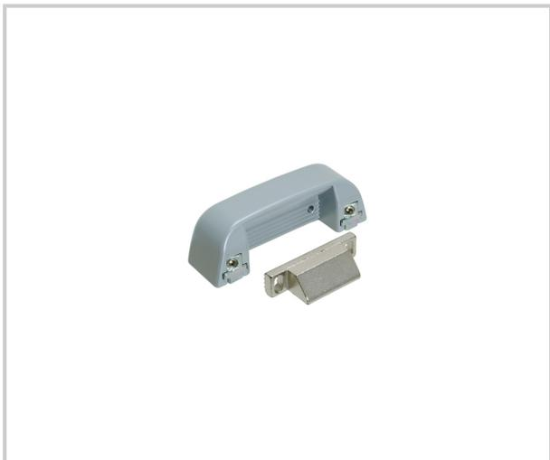
Gâche en zamac pour serrures centrales et pènes haut-bas (à exclusion de l'art. 84011), réglable verticalement et en horizontal. Applicable sur profils coplanaires et sur ceux à recouvrement jusqu'à 11mm, sans l'aide de cales supplémentaires.
