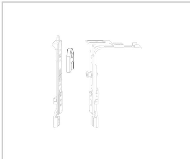
Gâche pour montage sur verrouilleur TESC sortie de tringle AF ou iP
