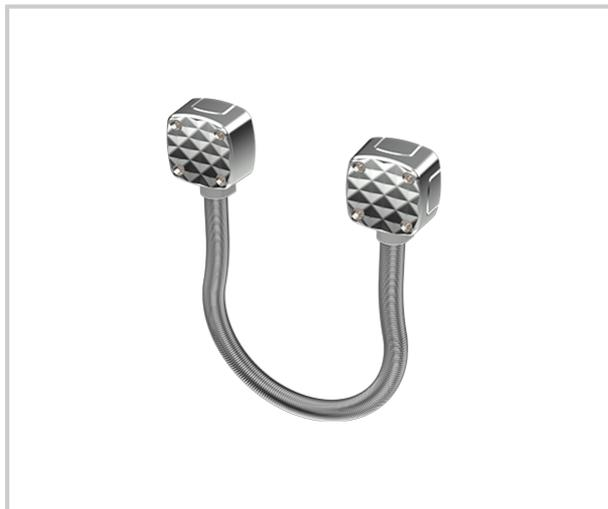
Passe-câble applique inox de diamètre intérieur 13 mm, diamètre extérieur 16,20mm et longueur : 40 cm.
