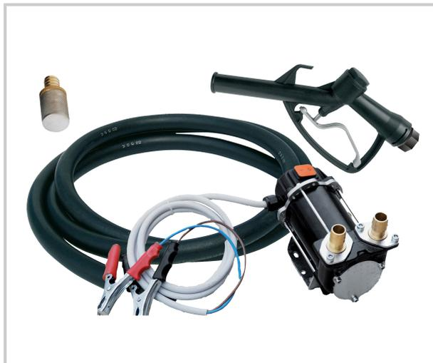
Pour gazole et fuel cycle de travail : 30 min raccordement 3/4" composé de : 1 pompe à palette auto-amorçante 12 V/150 W - débit 50 L/min - munie d'un système BYPASS, d'un interrupteur de mise en service et d'une protection par fusible 1 flexible de 4 m, Ø : 20 mm 1 crépine d'aspiration 1 pistoletplastique 1 câble d'alimentation de 2 m avec pinces.
