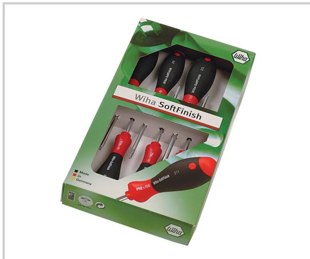
Jeu de 6 tournevis à fente/Pozidriv, 6 pièces, lames rondes. Acier à haute teneur en chrome-vanadium-molybdène, entièrement trempé, chromé mat. Pointe de la lame en ChromTop de Wiha: adhérence parfaite à la vis. Manche ergonomique SoftFinish multi-composants avec protection antidérapante. Pour les applications sèches et générales. Détail: Fente: 3,5x100, 4,5x125, 5,5x150 et 6,5x100. Pozidriv: PZ1x80 et PZ2x100.
