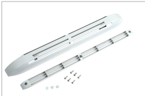
L'entrée d'air hygroréglable ISOLA HY se caractérise sous une différence de pression de 20Pa par un débit variable de 5 à 45 m<sup>3</sup>/h en fonction du taux d'humidité de la pièce.
