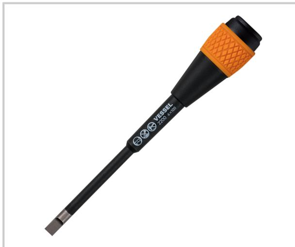
Lame renforcée avec traitement CR-V anti-corrosion lame fine (Ø 6 mm vs Ø 8 mm pour un tournevis standard) empêchant l'endommagement du bornier revêtement de la lame contre les accidents de court-circuitant intégré dans la lame permettant de maintenir fermement les vis en place.
