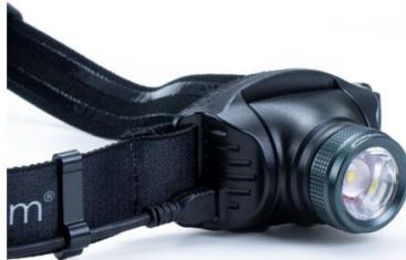
Système optique Hyperfocus coulissant qui collecte le rayonnement LED et le répartit avec une efficacité maximale focale réglable 10° - 70° avec mise au point coulissante variation de l'intensité lumineuse de 6 à 300lm, variateur avec mémorisation du dernier réglage, portée du faisceau 245m, angle d'éclairage réglable, protection IP54, poids 184g, livrée avec: manuel, batteries/piles, adaptateur secteur, câble USB, pochette.
