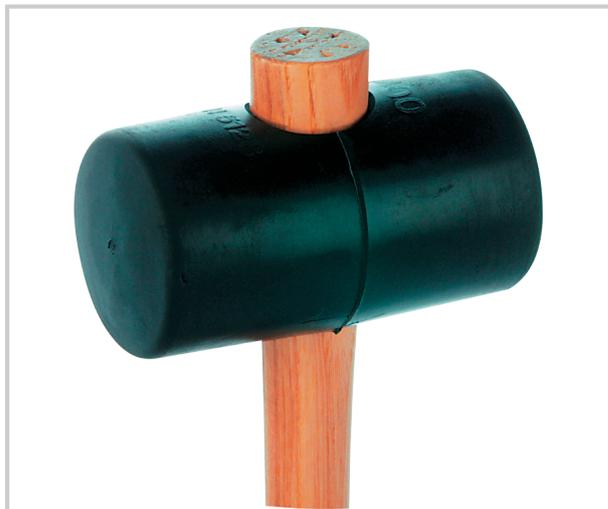
Permet de ne pas abîmer le matériau ou l'assemblage lors de la frappeusage : montage de meuble, parquet...tête en caoutchouc dure 85 +/- 5 Shore Atête légèrement bombéemanche à emmanchement conique.
