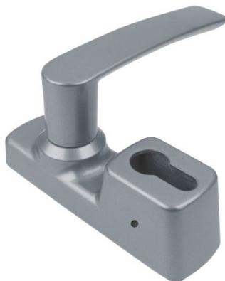
Corps et poignée en Zamak, mécanisme en acier, contre-plaque Zamak zingué. Pose facile grâce à 3 trous de diamètre 13 mm, fonctionnant seulement avec clef insérée.
