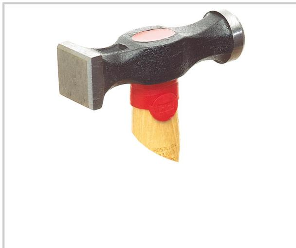
1 tête ronde quadrillée 1 tête carrée pièce fine (existe en 40/35 sur demande) tête en acier à forte teneur en carbone C45 tête forgée, avec traitement thermique par induction des surfaces travaillantes (54 HRC) parties travaillantes et joues finement polies peinture poudre époxydique par procédé électrostatique, suivi d'une cuisson au four manchement réalisé par une machine hydraulique.
