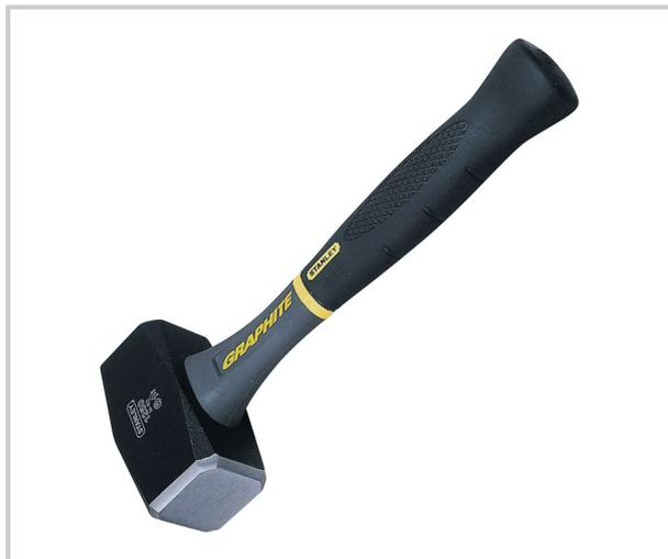
Tête plate et angles abattus pour accroître la sécurité. Très bonne prise en main et excellent équilibre. Amortisseur de vibrations par la combinaison d'un revêtement élastomère souple et d'une âme graphite : 5 fois moins de vibrations qu'un manche bois. 1 kg 500.
