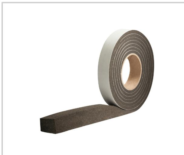
COMPRIBAND TRS est une mousse de polyuréthane imprégnée de résines synthétiques, comprimée avec une face adhésive. Il assure l'étanchéité à l'eau et à l'air des menuiseries et des joints de façades.
