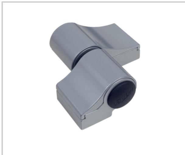
Paumelle à deux lames en aluminium extrudé. Douille supérieure de zamak, pré montée sur l'axe en acier inox rectifié.
