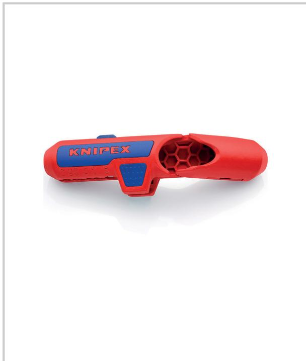
Pour le dégainage et le dénudage rapide et précis de tous types de câbles ronds et hydrofuges standards (par ex., câble NYM 3 x 1,5 mm<sup>2</sup> jusqu'à 5 x 2,5 mm<sup>2</sup>), câbles de données (par ex. paires torsadées) et câbles coaxiaux
