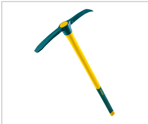
Pour manipuler les plaques d'égouts: dégager l'enrobé des bords de la plaque, soulever et faire glisser la plaque. Outil forgé et trempé. Manche Novagrip de 90 cm en fibre de verre un côté bec pour soulever et faire glisser la plaque, un côté panne pour dégager l'enrobé des bords de la plaque. Poignée élastomère anti-glissement et anti-vibration. Diamètre douille : 48 mm.
