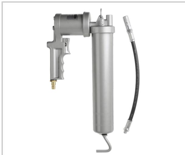
Permet d'utiliser des graisses jusqu'à la classe NLGI 2 en cartouche de 400 gr ou vrac équipé d'un flexible haute pression, M 10 x 1 / 11 x 300 mm, d'une agrafe de précision 4 BA, M 10 x 1 f et d'une valve de remplissage (FN), M 10 x 1 m
