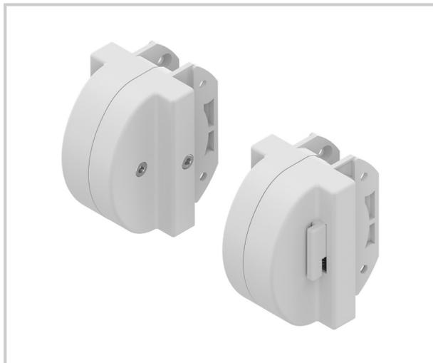
Pivot à frein réglable, limiteur d'ouverture à 30° et blocage de sécurité à 180° (système automatique breveté) pour châssis équilibré jusqu'à 150 Kg.
