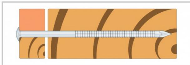
Les pointes annelées inoxydables sont principalement utilisées pour la fixation de bardage bois en extérieur.
