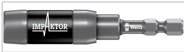
Porte-embouts Impaktor permettant d'amortir les pics d'impulsion extrêmes effet « torsion » très poussé grâce aux deux éléments à ressort avec aimant annulaire, pour un maintien aisé des vis même longues et lourdes l'aimant est rétractable, ce qui permet sa neutralisation convenant pour embouts à emmanchement hexagonal 1/4 " selon DIN 3126-C 6,3 et de la série 1 Wera.
